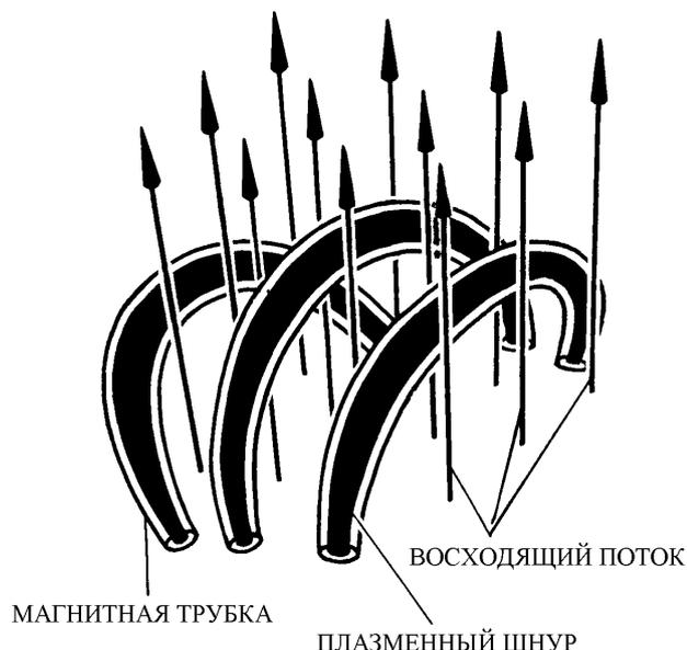
*Модель восходящего ускоряющегося потока солнечного ветра между дискретными арочными структурами хромосферы и короны Солнца. Восходящий поток плазмы, за счёт вязкого взаимодействия, вытягивает арочные структуры и может выносить их образуя петли в межпланетной среде.*
